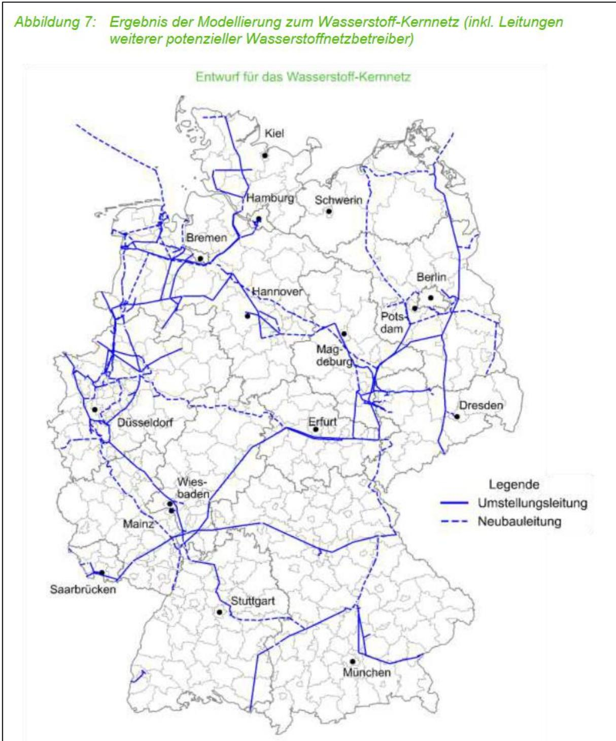
Abb. 6: Entwurf des Wasserstoff-Kernnetzes durch die Vereinigung der Fernleitungsnetzbetreiber Gas e.V. (Stand 15.11.2023)
